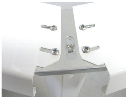
Wenn alle Handlaufschienen montiert sind, werden die Innen- und Außenkappen mit der Zentralschraube von oben angeschraubt.
